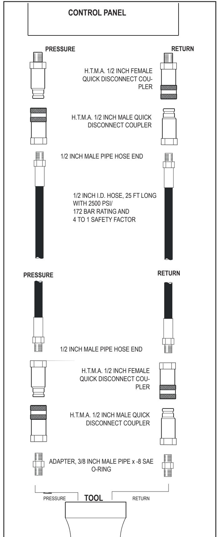
Figura 2. Conexiones Hidráulicas
