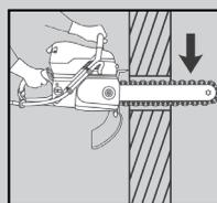
3. Inserire la punta di WallWalker® ruotata verso l'alto
