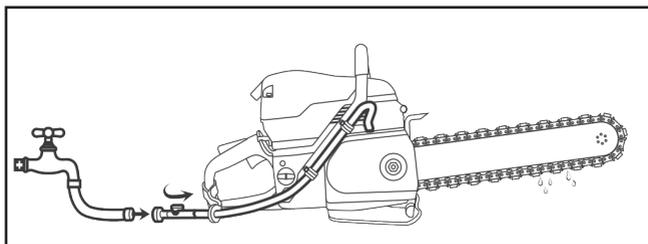
Allacciarsi a un'alimentazione d'acqua in grado di erogare una pressione di 1.5 bar a una portata minima di 4 lpm. Il fattore più importante che l'operatore può controllare per aumentare la durata della catena è usare un'adeguata pressione idrica.
